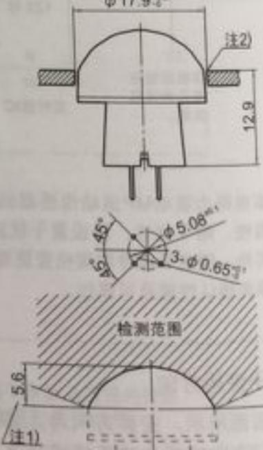
注) 1. 为确保检测性能, 安装透镜时, 请使透镜前端伸出5.6mm以上。
